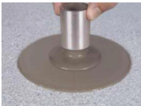
Figura 3.9 – Equipamento “anel de fluxo” para o ensaio de retenção de fluxo. Fonte: Guimarães, 2013.
