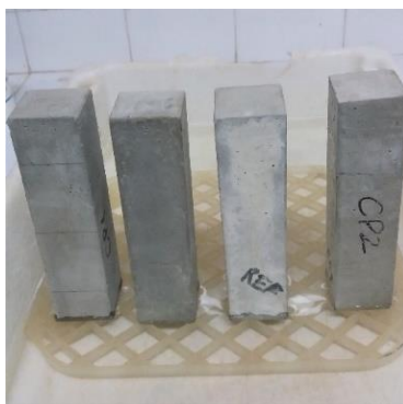
Figura 3.16 – Procedimento de ensaio de absorção de água por capilaridade. Fonte: autora
