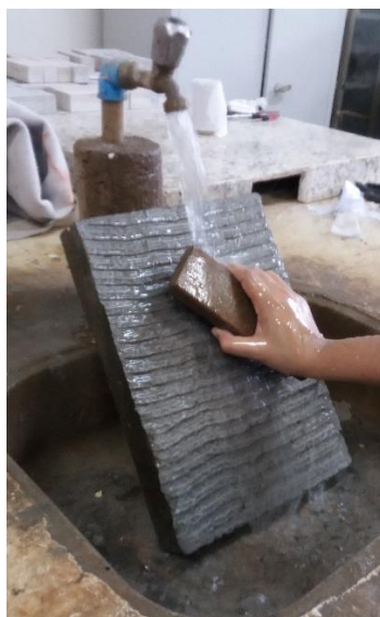
Figura 3.22 – Preparo do substrato antes da aplicação das argamassas. Fonte: autora.
