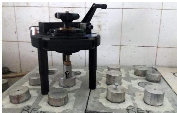
Figura 3.19 – Equipamento utilizado para o ensaio de resistência de aderência à tração.
