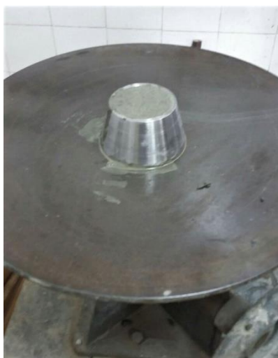
Figura 3.10 – Equipamento mini Slump-test utilizado para o ensaio de retenção de fluxo. Fonte: autora.
