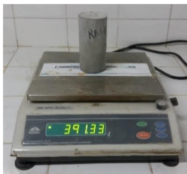
Figura 3.15 – Procedimento de ensaio de determinação da densidade de massa aparente.
