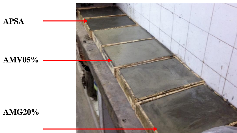
Figura 3.23 – Argamassas autonivelantes após aplicadas aos substratos Fonte: autora.
